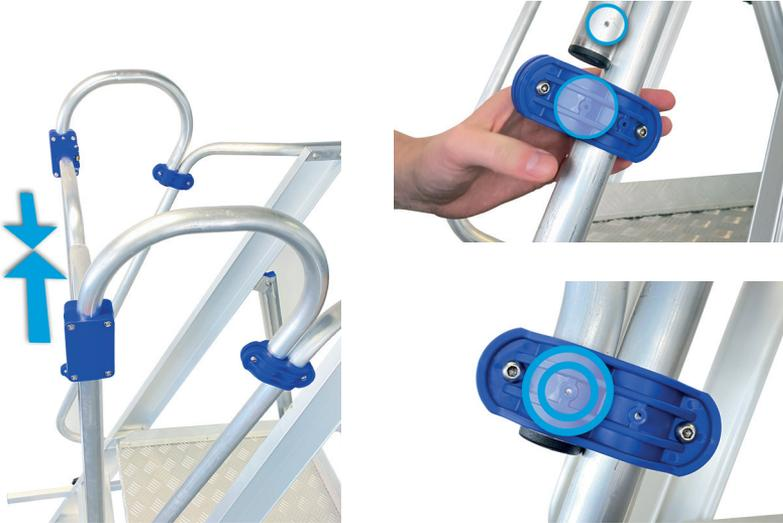
5. Pour finir, fixez l'ensemble en insérant les vis autotaraudeuses fournies dans les brides d'accouplement et serrez avec une force de 5 Nm, à la fois dans la main courante et dans l'étrier du ZVD à l'intérieur et à l'extérieur.
