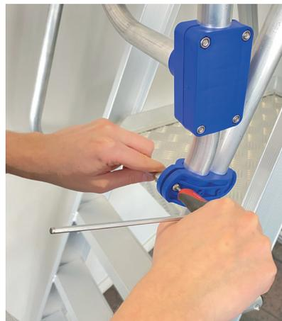
4. Lorsque les deux portillons sont en place, alignez-les l'un par rapport à l'autre. Pour redresser les brides d'accouplement, alignez le trou avant sur le trou dans l'étrier.
