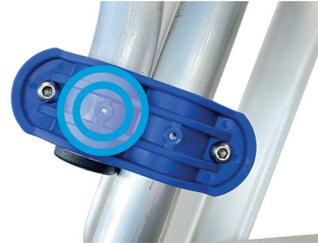
5. Sichern Sie abschließend die Konstruktion, indem Sie die mitgelieferten selbstschneidenden Schrauben in die Kupplungsschellen einsetzen und mit einer Kraft von 5 Nm sowohl im Geländer als auch in der Halterung der selbstschließenden Sicherheitstür auf der Innen- und Außen-seite anziehen.
