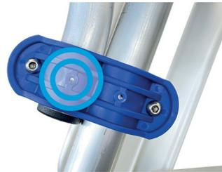
5. Tot slot het geheel borgen door de bijgeleverde zelf tappende schroeven aan te brengen in de koppelklemmen en aandraaien met een kracht van 5 Nm, zowel in de trapeleuning als in de ZVD-beugel aan de binnen- en buitenzijde.
